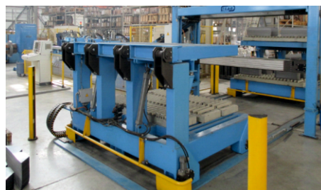
Линия поперечного раскря электротехнической стали с раскладчиками
